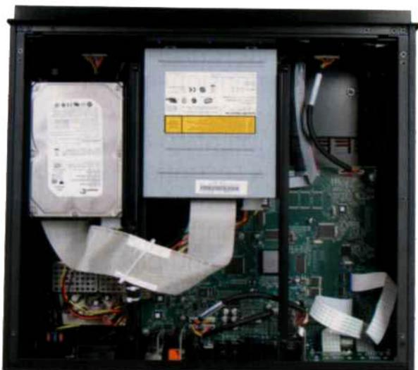
**CUORE INFORMATICO** Il progetto dell'interno denuncia una chiara origine informatica: la meccanica è una Sony CRX230, l'hard disk è un Seagate, entrambi con interfaccia IDE; sotto il disco è posto l'alimentatore ATX. La mainboard è marcata Escient, nome noto nel campo, parte come McIntosh del gruppo D&M Holdings. Al centro della scheda il controller per la gestione del sistema, la compressione è svolta da una CPU Texas Instruments TMS320D, la conversione A/D e D/A è demandata a un AKM 4584.
